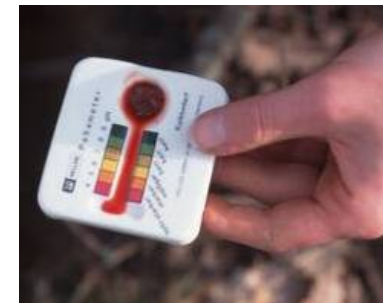
Mesura de l'acidesa amb pHmetre de tires de paper
