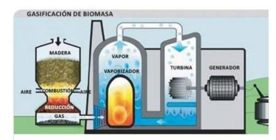
Figura 1: Esquema del proceso de gasificación de biomasa.
