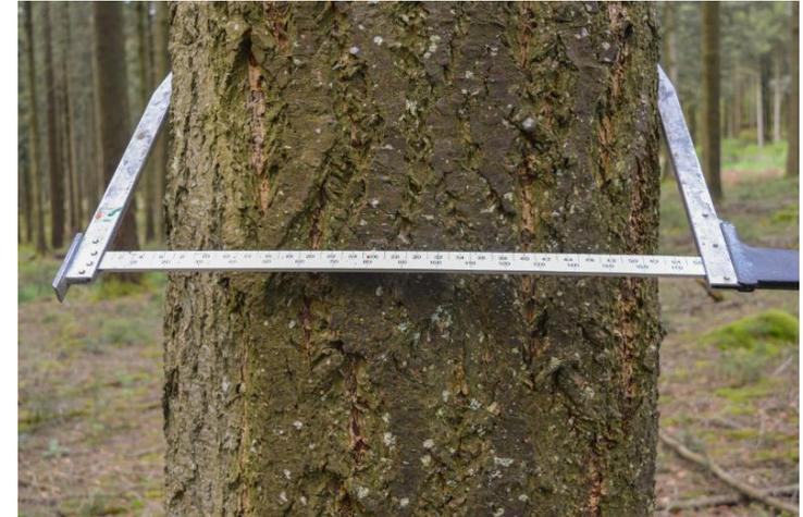
*Mesure de diamètre sur Douglas*
