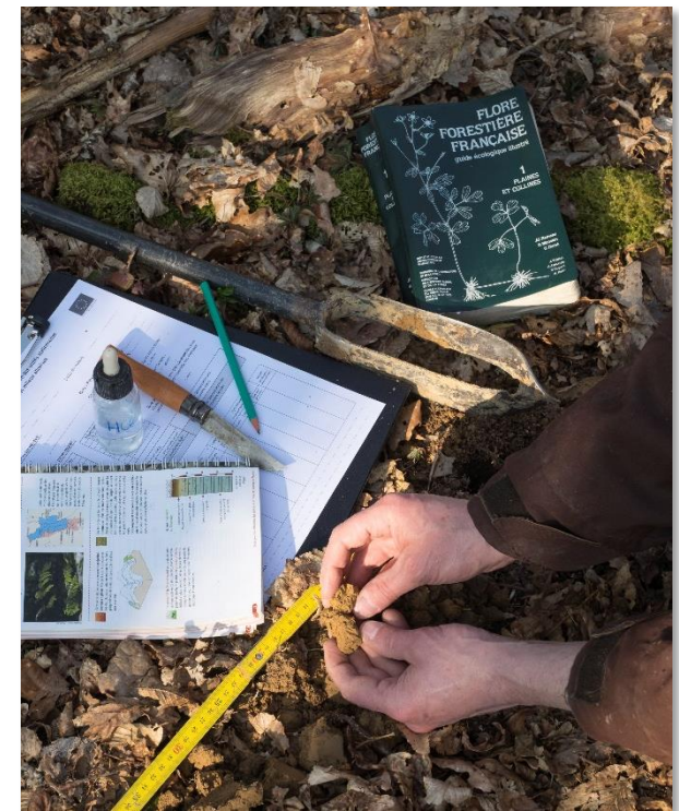
Le matériel de base pour un diagnostic de terrain : pioche, tarière, acide chlorhydrique, flore, guide des stations...
